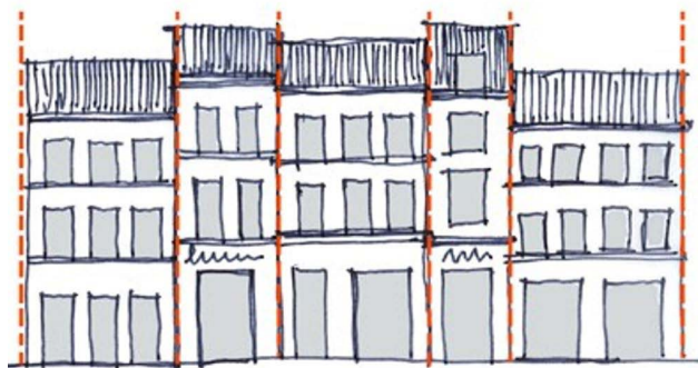
Principe de l'abaissement des trumeaux d'anciens rez-de-chaussée commerciaux.
